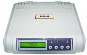
ACC-3000 是一款 SHDSL (Single-pair Highspeed DSL, 单对线路高速对称数字用户线) 设备, 它是高速数据传输和接入的最佳解决方案。它提供迄今为止 DSL 技术具有的最大功用范围, 能够用于语音、数据和视频等多种业务类型。与其它 DSL 设备相比, ACC-3000 具有更高的带宽, 最大带宽 2.3Mbps; 更远的传输距离, 最大传输距离 8.4KM; 由于完全遵循 ITU 的 G.SHDSL 标准, 也具有更好的兼容性。ACC-3000 采用 TC-PAM 编码, 基于 TDM, 更适合中国的电信运营商。它提供 G. 703、V. 35、10/100Base-T、RS-449、EIA-530 多种用户接口, 可以最大限度满足用户需求。已经在电信、铁路、军队、水利电力等行业得到大量应用。
